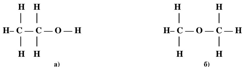
Рис. 2. Структурные формулы альтернативных топлив. Обозначения: а) этиловый спирт, б) диметилэфир. 2 pav. Alternatyvių degalų struktūrinės formulės. Žymėjimai: а) etilo spiritas, б) dimetilefiras
